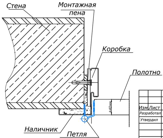
Размеры распашных дверей металлическая угловая и обжимная коробка
